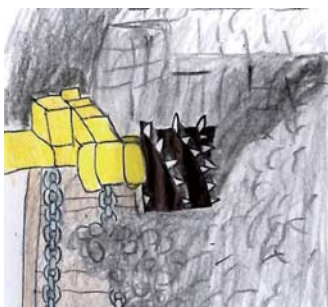
ドラムカッターで掘った石炭をチェーンコンベアで運ぶ様子
